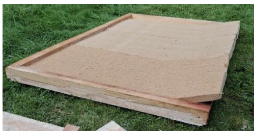
Fabrication de la partie isolée du capteur
