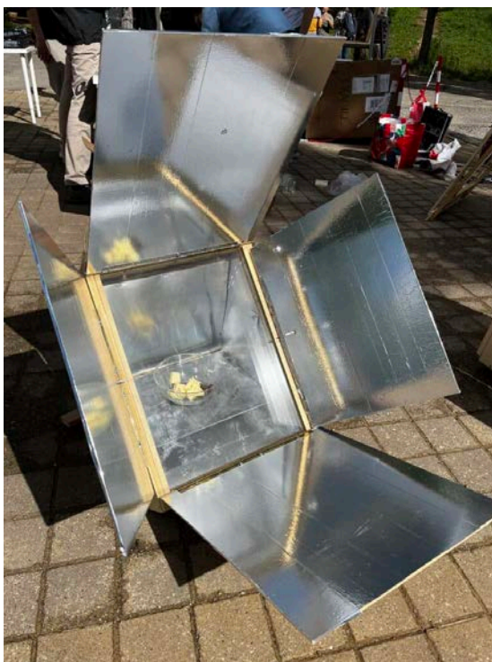
Exemple de four solaire développé par les étudiants ingénieurs de Mines Paris - PSL 44
